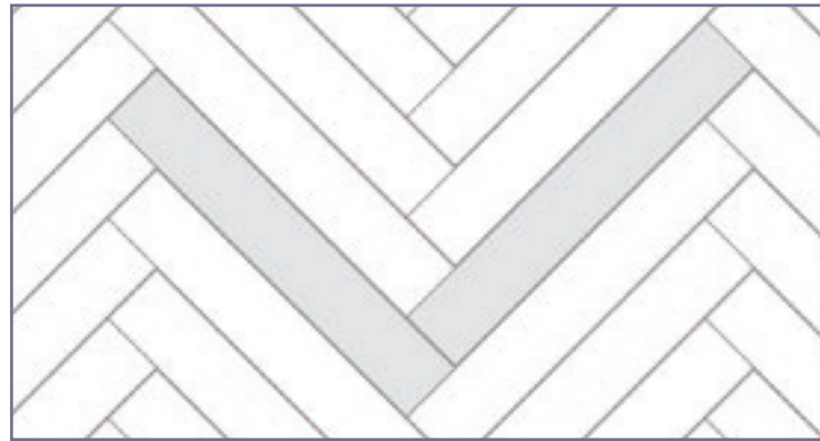
Colocación en espiga
